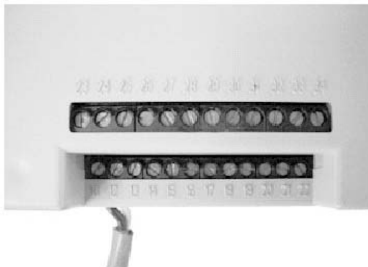
Рис. 2.10 – Контроллер SMC-Flex – Клеммы сигналов управления
