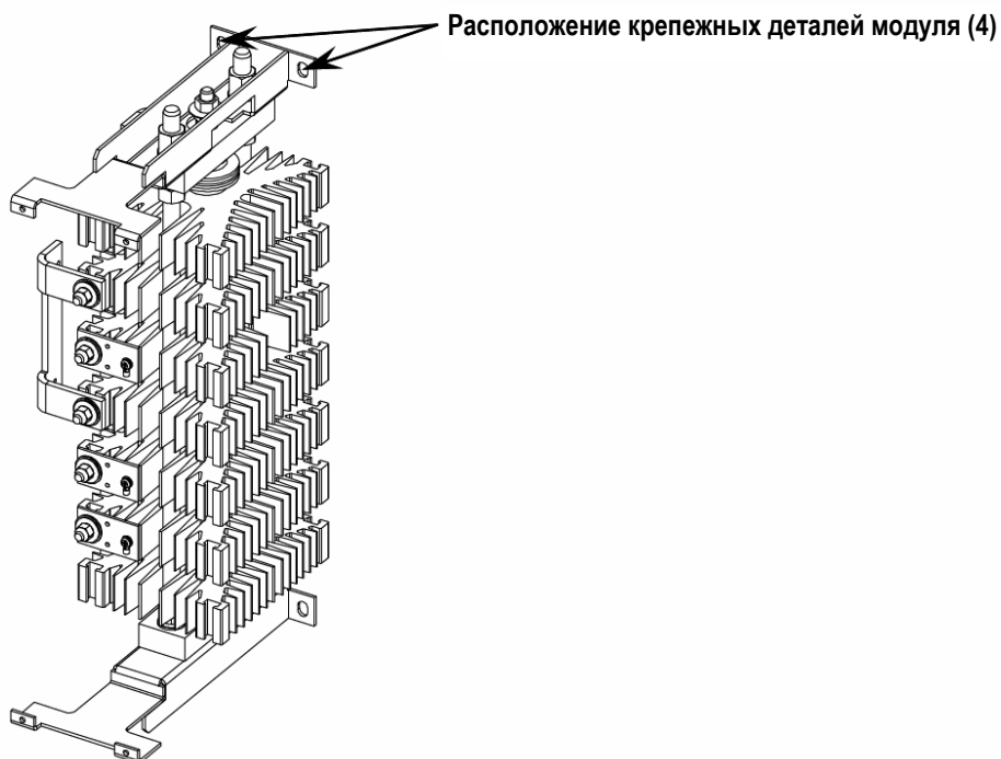
Рис. 9-13 Сборка силового модуля (одна фаза) со снятыми платами формирователей и корпусом • 5500 / 6900 В, 180 А / 360 А
