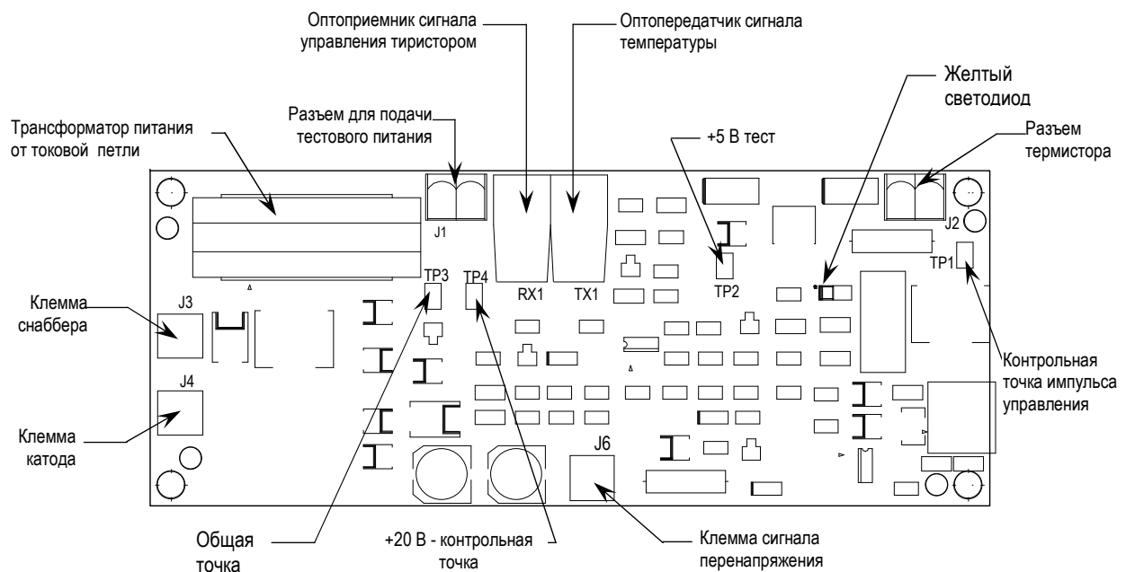
Рис. 3.4 - Использование тестового источника питания на плате формирователя импульсов управления тиристором
