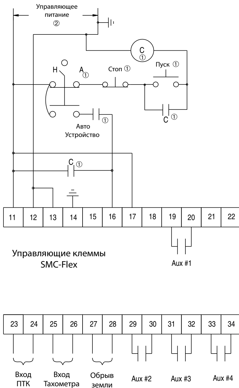
Рис. 3.21 Типичная схема подключения для управления «Вручную-ВЫКЛ-Авто» с опцией останова кнопками «Пуск/Стоп»
