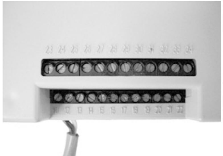
Рис. 3.10 Клеммы управления контроллера SMC-Flex
