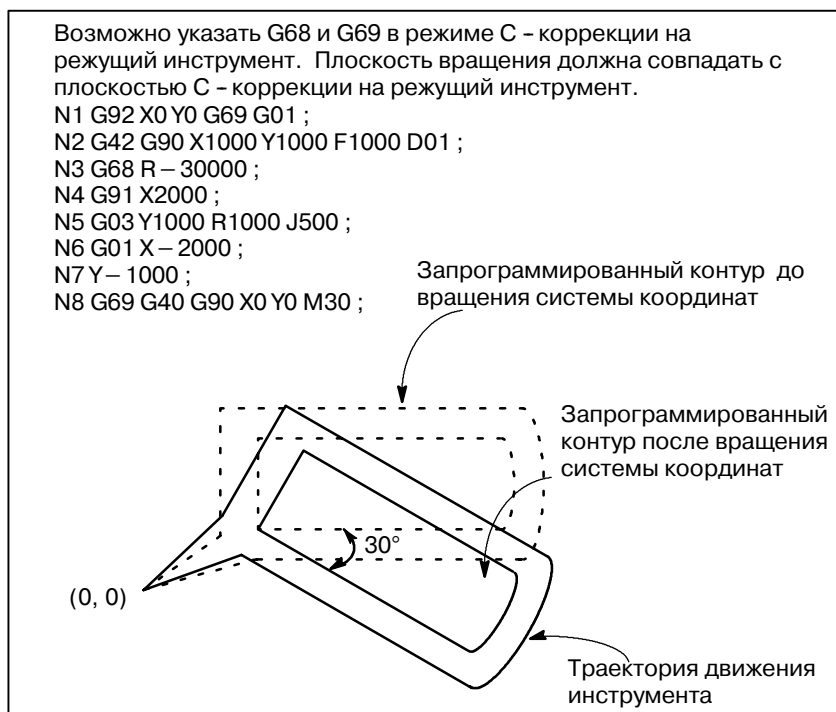
Рис. 14.8 (d) C - коррекция на режущий инструмент и вращение системы координат
