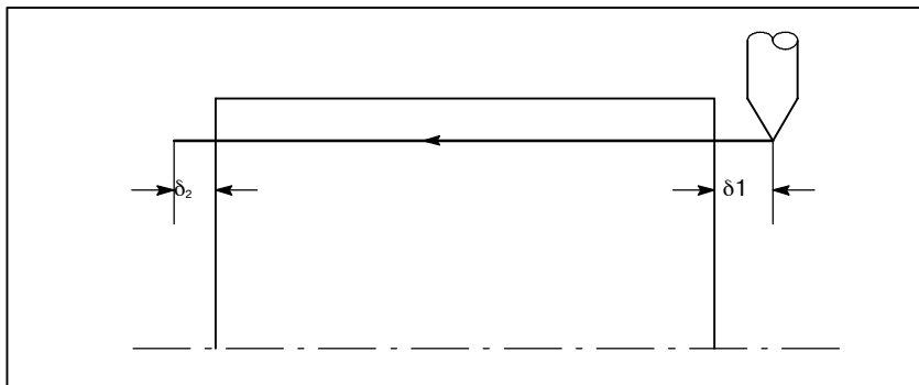
Рис. D.2 (а) Участок с неверной резьбой
