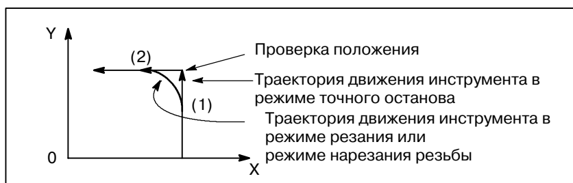
Рис. 5.4.1 Пример траекторий движения инструмента от блока (1) к блоку (2)
