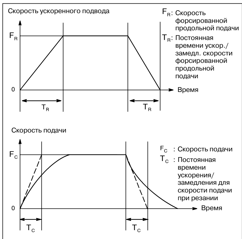
Рис. 5.1 (а) Автоматическое ускорение/замедление (пример)
