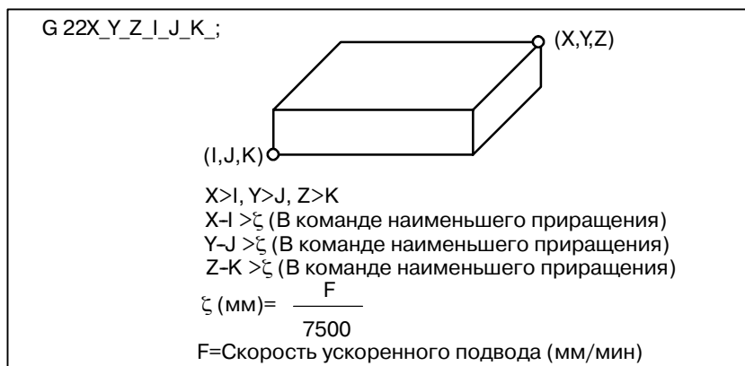
Рис. 6.3 (b) Создание или изменение зоны запрета с помощью программы
