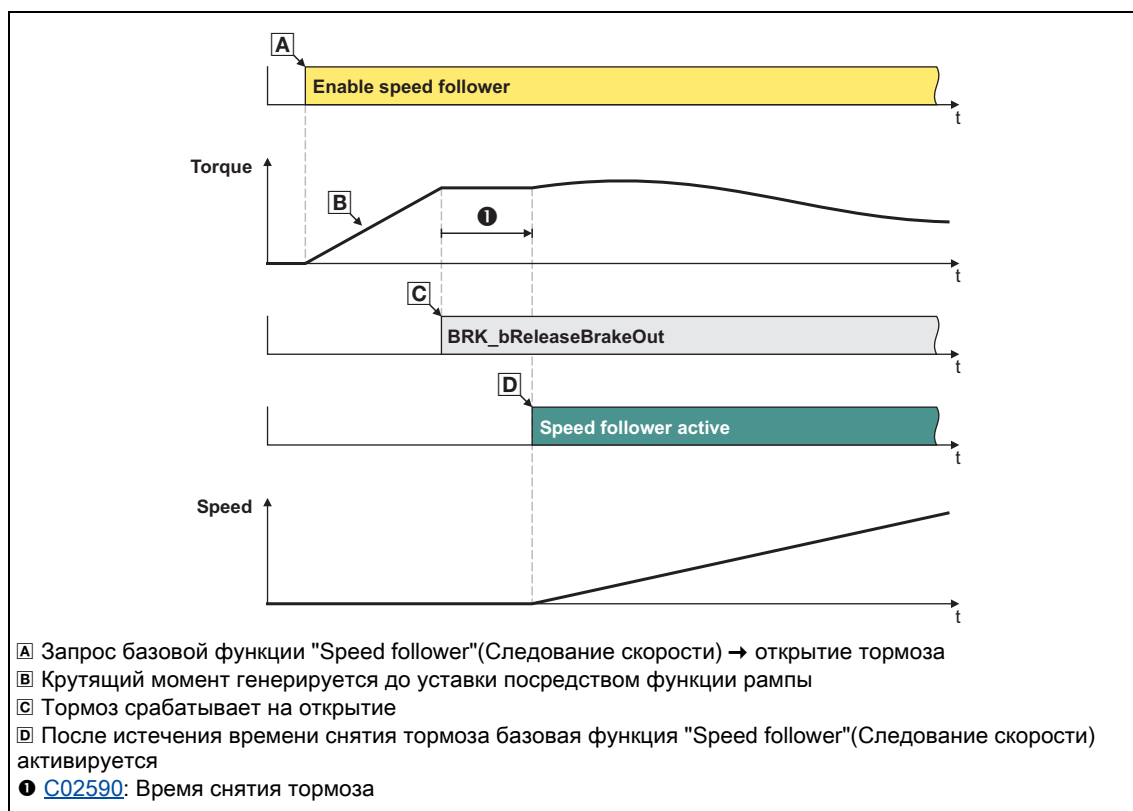
[11-41] Последовательность упреждающего управления моментом посредством функции рампы
