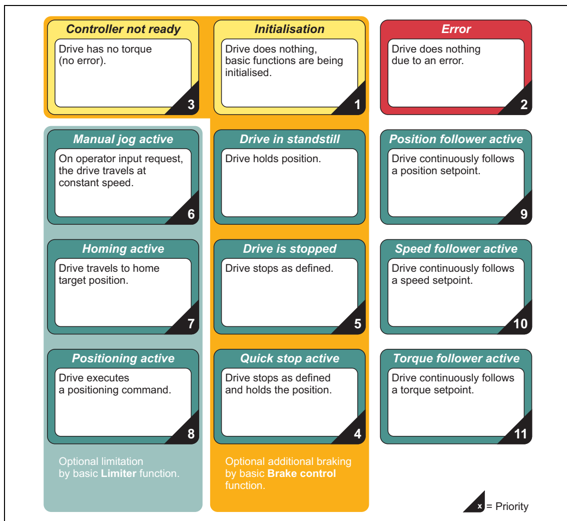
[11-1] Функциональные статусы машины состояний "Базовые функции"
