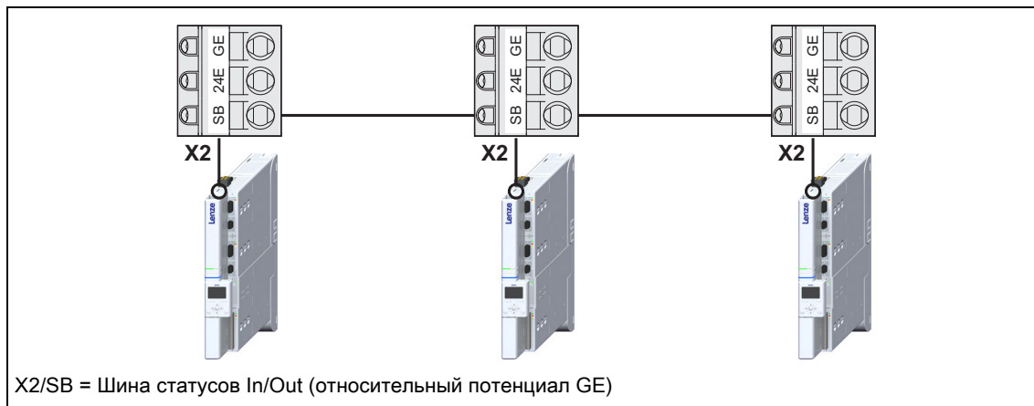
[8-1] Структурная схема: Сеть посредством шины статусов
