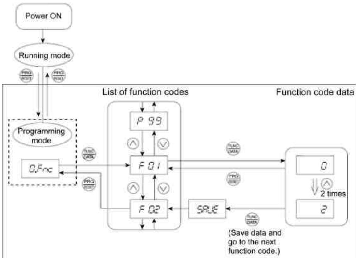
Рисунок 3.3 Пример процедуры изменения значения функционального кода.
