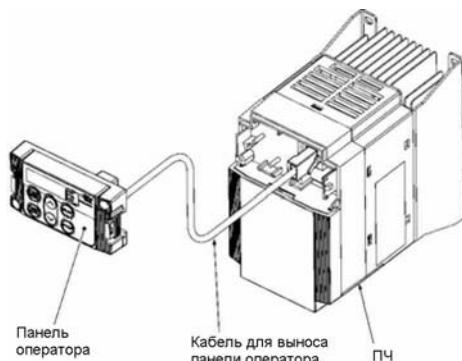
Рисунок 2.24 Установка панели оператора на расстоянии (для удобства управления)
