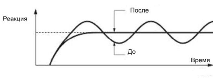
4) Подавление колебаний по периодичности приблизительно равных периоду, установленному функциональным кодом J05 (дифференциальное время)
