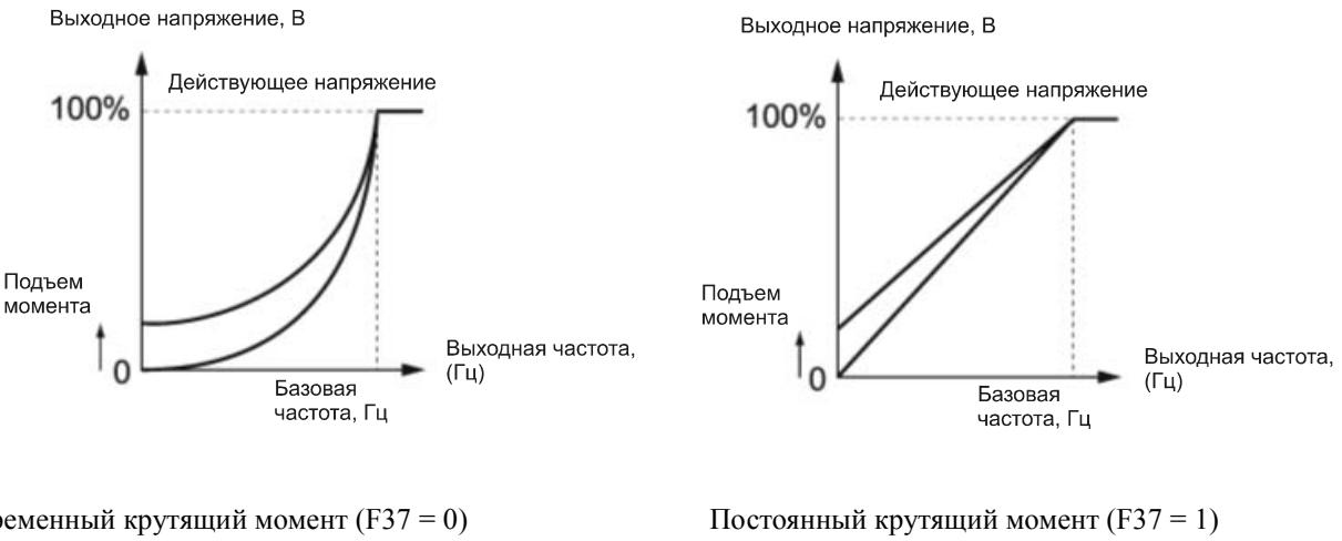
При установке переменного момента v/f характеристики (F37 = 0 или 3) напряжение при малой частоте может быть мало и нестабильно, это может привести к потере момента в области малой частоты и неработоспособности механизма. Для того, чтобы этого избежать рекомендуется увеличить выходное напряжение в области низких частот, при помощи нелинейной вольт-частотной характеристики.
