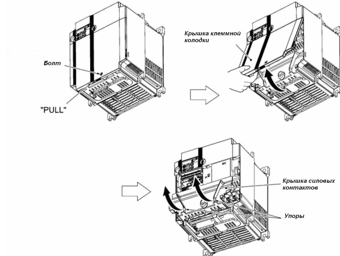
Рисунок 2.7 Снятие крышек (для ПЧ мощностью 11 и 15кВт)
