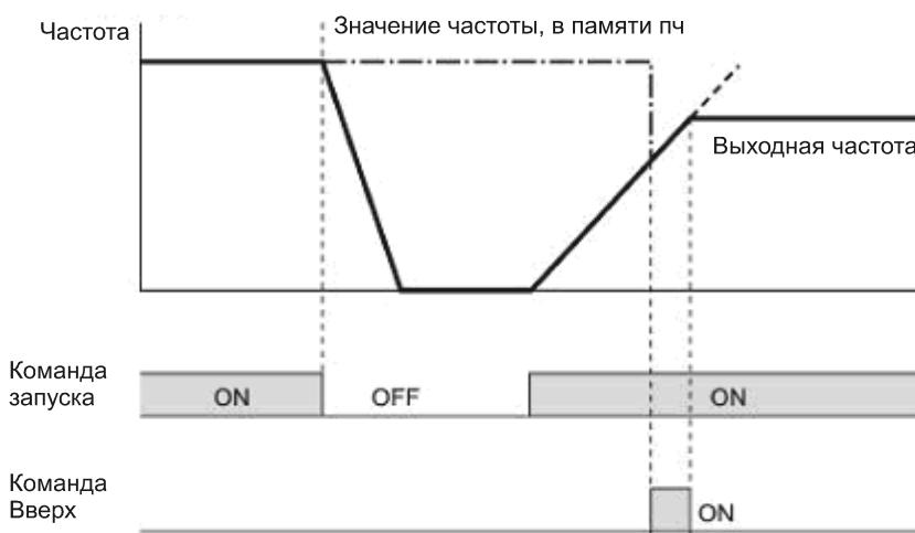
Изначальные установки настройки ВВЕРХ/ВНИЗ при переключенном источнике команды частот: Если источник команды частоты переключен на настройку ВВЕРХ/ВНИЗ из других источников, изначальные установки настройки ВВЕРХ/ВНИЗ будут следующими:
