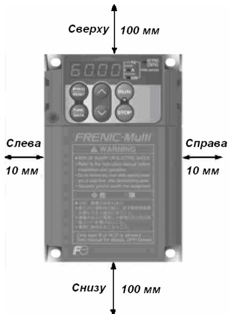
Рисунок 2.1 Положение при установке и необходимые зазоры
