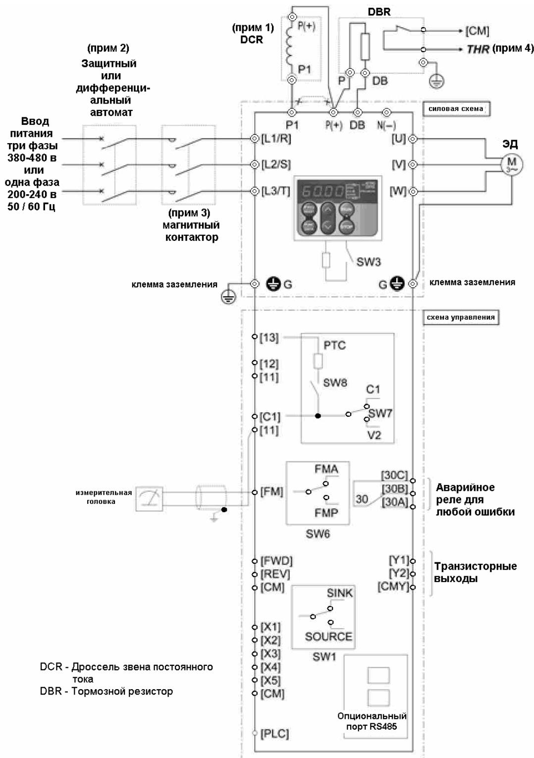
Прим. 1: При установке дросселя удалите перемычку между клеммами P1 и P(+).
