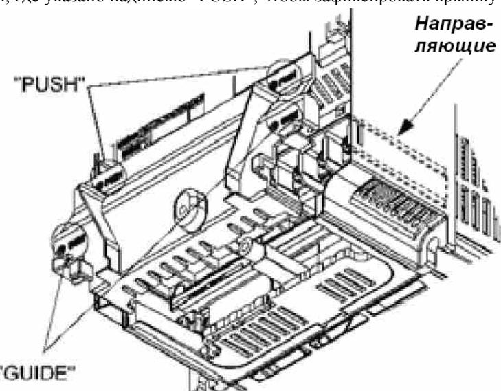
Рисунок 2.8 Установка крышки силовых контактов.
