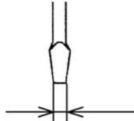
Толщина жала отвертки: 0.6 мм,ширина 3.5 мм
