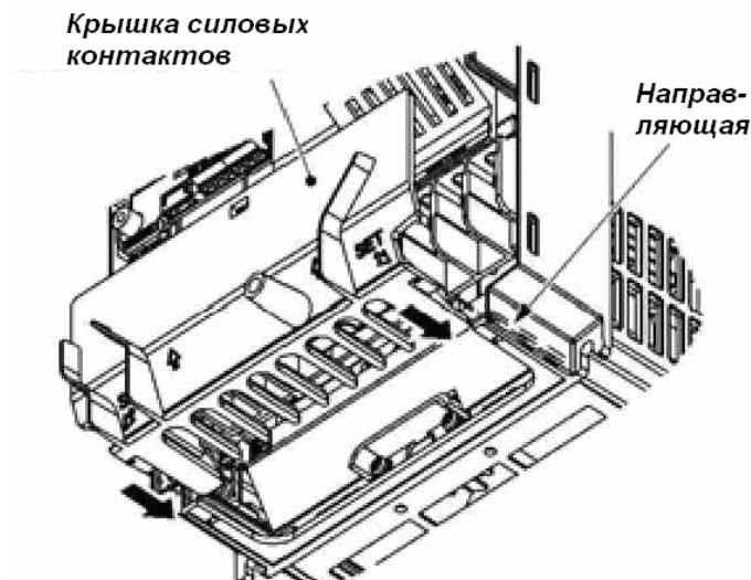
Рисунок 2.6 Установка крышки (для ПЧ мощностью 5.5 и 7.5 кВт)
