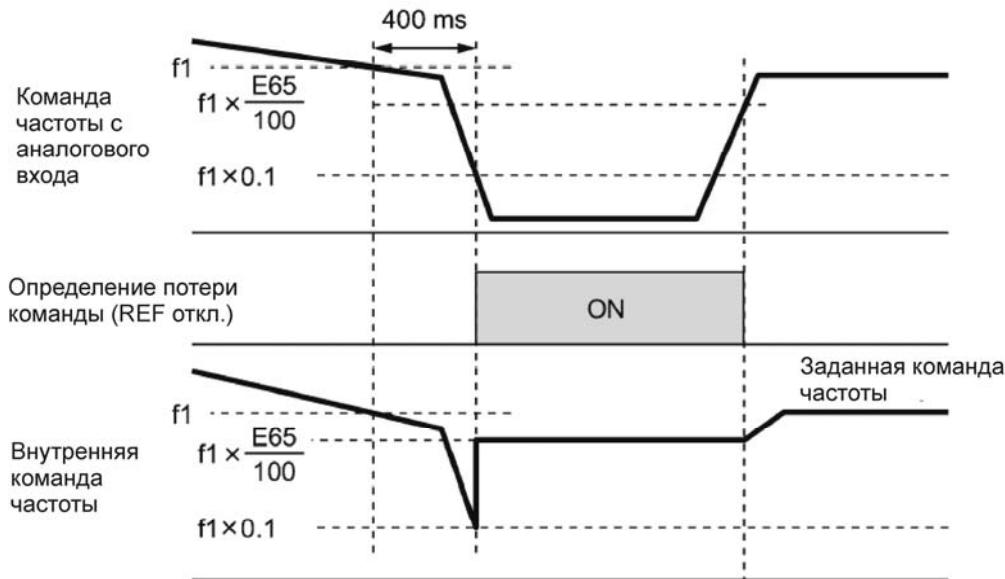
На верхней диаграмме  $f_1$  является уровнем аналоговой команды частоты, измеряемым в любое время. Измерение повторяется с регулярными интервалами для контроля за линией команды установки частоты.
