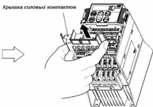
Рисунок 2.4 Снятие крышек.
