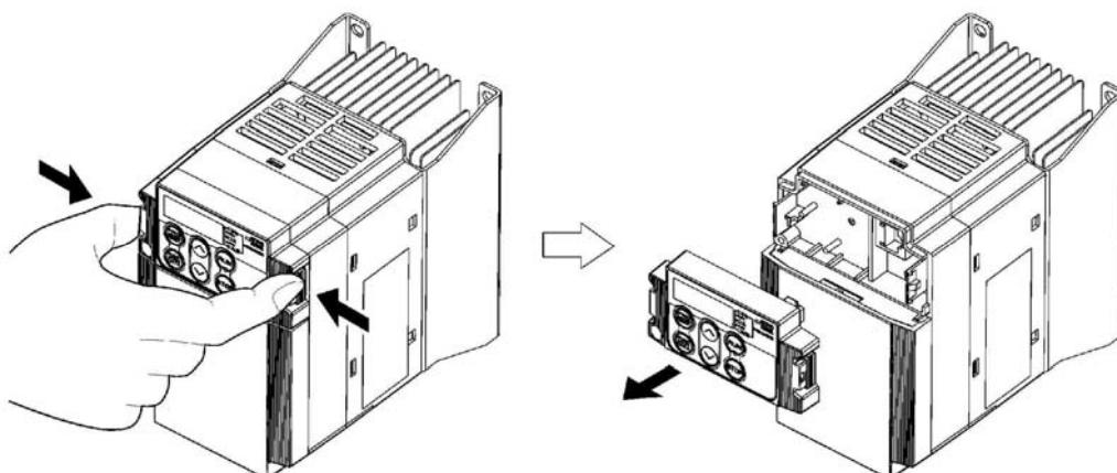
Рисунок 2.25 Снятие панели
