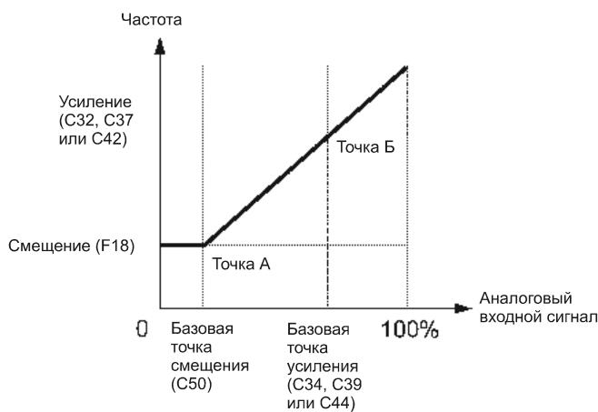
Пример: Установка смещения, усиления и его базовой точки при диапазоне аналогового ввода 1 – 5 В DC для команды частоты 1.
