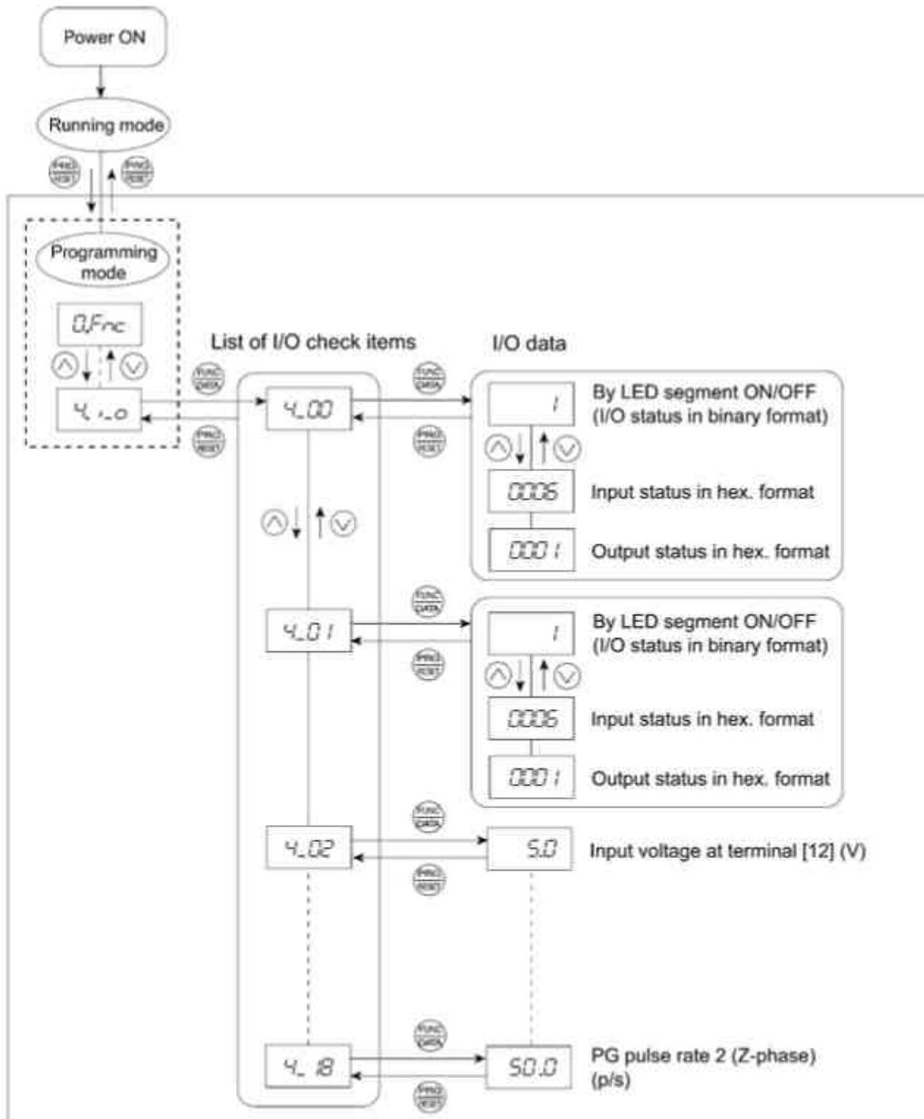
Рисунок 3.5 Переходы Меню #4 "Проверка входа/выхода"
