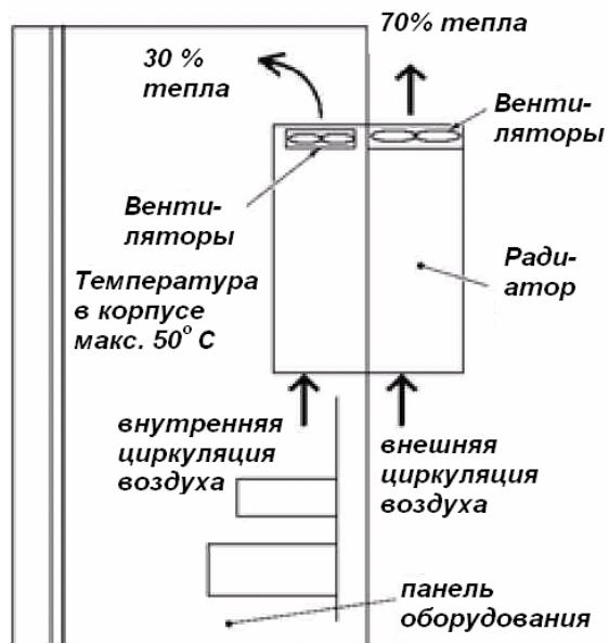
Рисунок 2.2 Внешнее охлаждение
