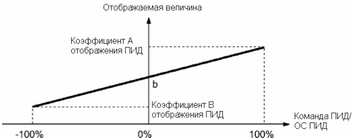
Если выход датчика однополярный, то ПИД-регулировка натяжения действительна в диапазоне от 0 до +100%. Т.е., для корректной работы задайте величину -100% в качестве коэффициента В.
