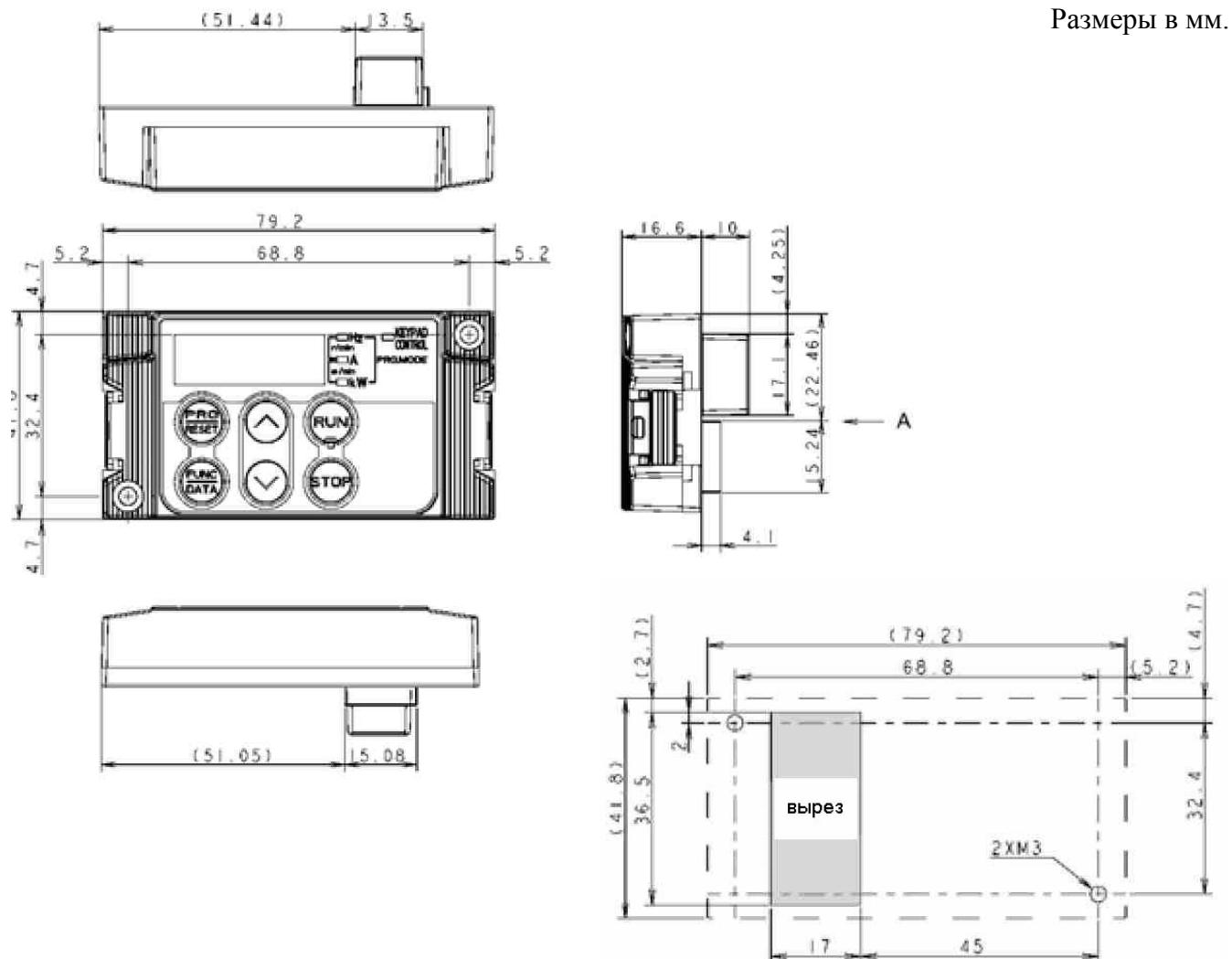
Размеры отверстий для монтажа панели
