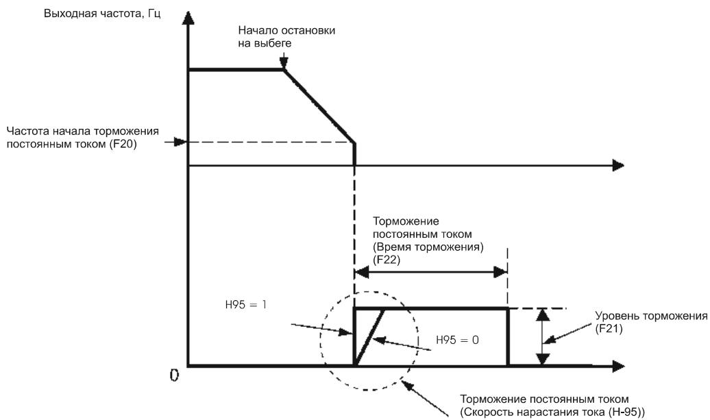
**Tip** Можно также использовать сигнал цифрового входа, как команду торможения пост. током (DCBRK).
