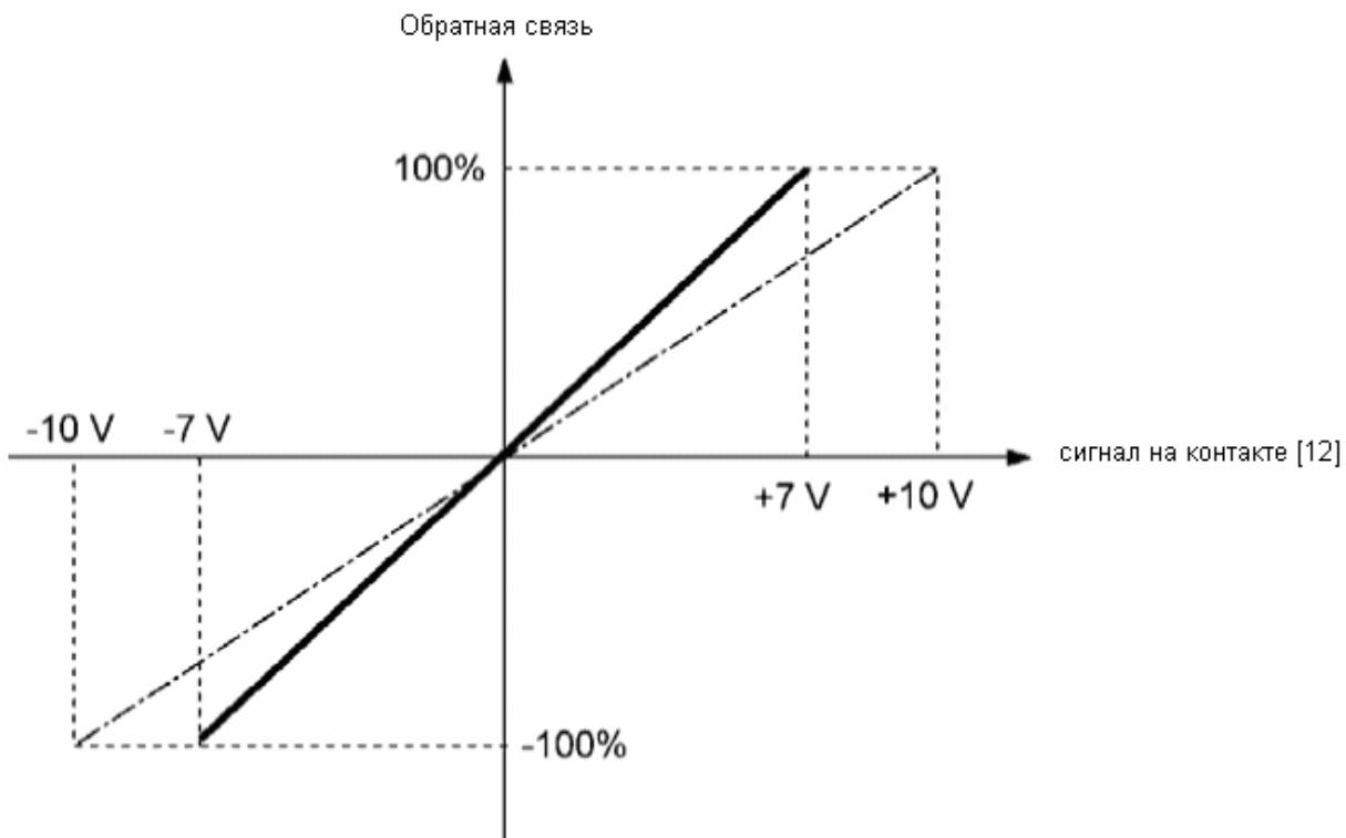
Пример 2. Если напряжение выхода датчика находится в диапазоне от 0 до 10 В постоянного тока, то:
