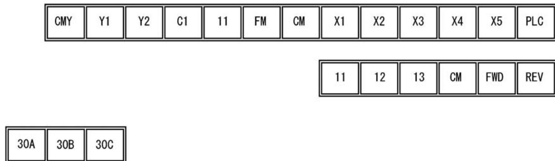
Размеры болтов: М3 момент затяжки: 0.5-0.6 (Н/м)
