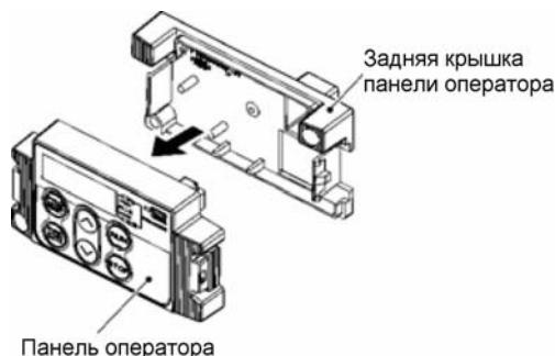
Рисунок 2.26 Установка задней крышки панели для работы на расстоянии
