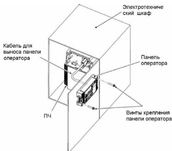
Рисунок 2.23 Установка панели оператора на стенку панели
