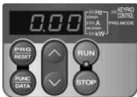
Рисунок 4.2 Изображение на индикаторе после включения электропитания
