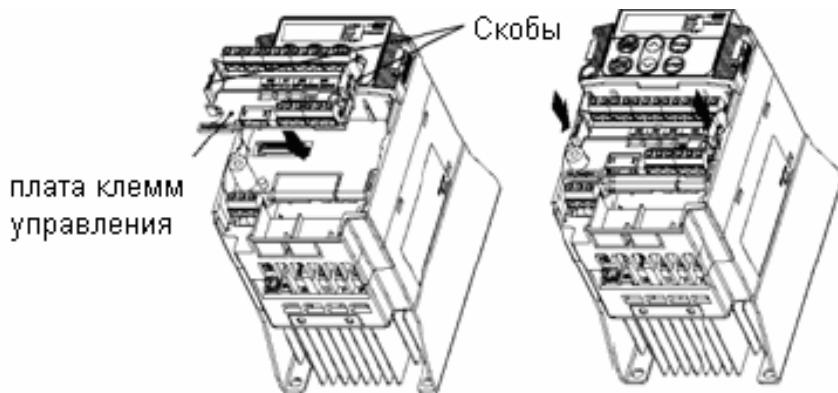
Рисунок 2.21 Установка платы клемм управления
