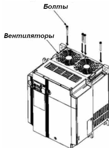
Рисунок 2.3 Крепление охлаждающих вентиляторов
