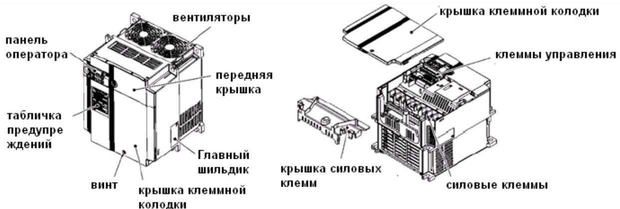
Рисунок 1.2 Внешний и внутренний вид ПЧ (FRN15E1S-4E)
