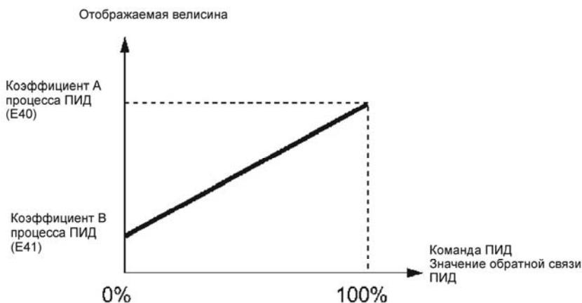
Пример: Если Вы хотите поддерживать давление 16 кПа, выберем датчик давления с диапазоном например 0-30 кПа и выходным сигналом 1-5 В (напряжение с датчика при давлении 16 кПа будет около 3.13 В).
