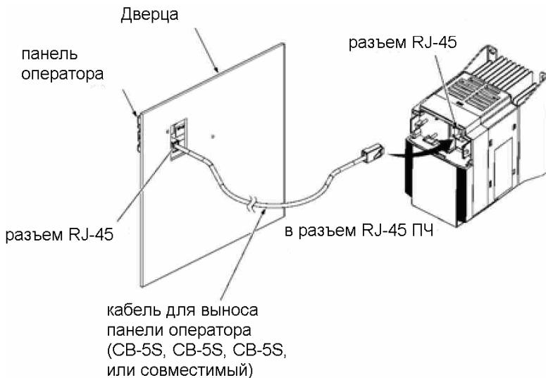
Рисунок 2.28 Подключения удлинительного кабеля
