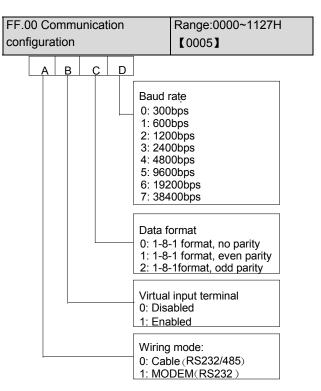
Fig. 5-69 Communication parameters
