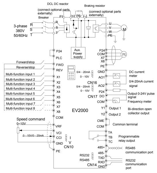
Fig. 3-9 Basic wiring 1
