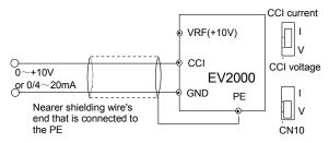
Fig. 3-15 Wiring CCI
