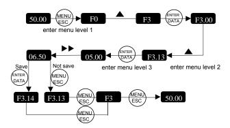
Fig. 4-7 Setting the parameters
