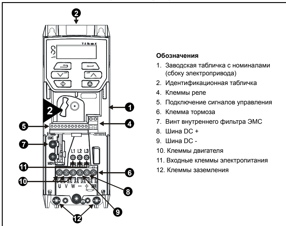
Рис. 3-1 Расположение деталей (показан габарит 2)
