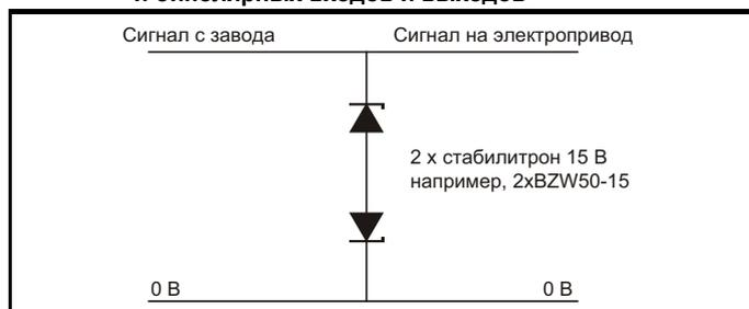
Подавители выбросов выпускаются как устанавливаемые на рейке модули, например, производства компании Phoenix Contact:
