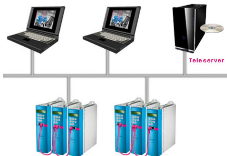
Рис. 11-19 Дистанционное обслуживание через удаленный сервер
