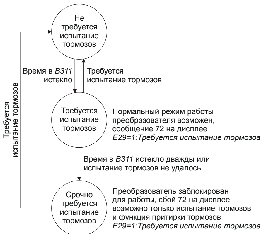
Рис. 7-5 Управление тормозом модуля контроля состояний
